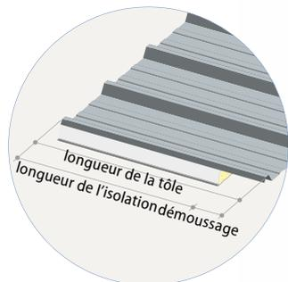
Veuillez indiquer la longueur de la tôle et de l'âme isolante. Longueur de l'âme isolante min. 2,50m. Longueur max. de la tôle: 16m. Démoussage 50mm min. (standard) 350mm max.
