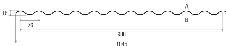
**APPLICATION** Tôle pour bardage ou toiture / bardage pose horizontale ou verticale
